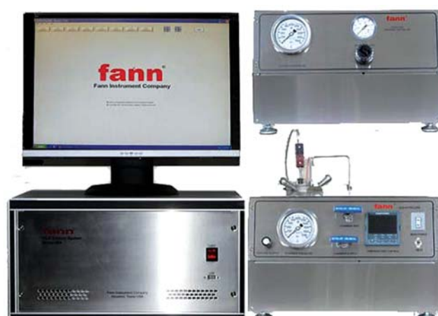
Hình 3. Thiết bị xác định độ bền đá xi măng bằng siêu âm UCA
